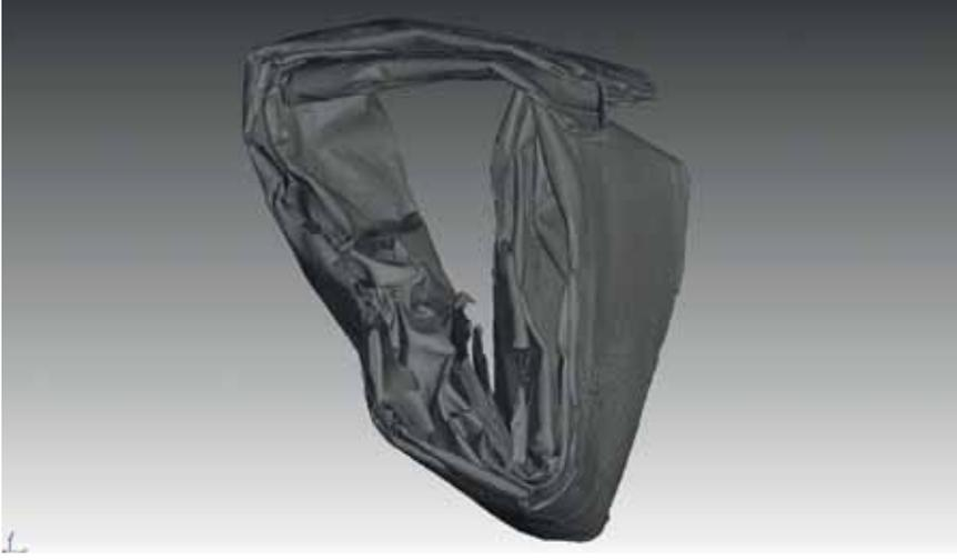
Abb. 3: CT-Scans der gefalteten Bleche erlauben die Untersuchung der Stücke, ohne sie zu zerstören (© VARUSSCHLACHT im Osnabrücker Land gGmbH).
