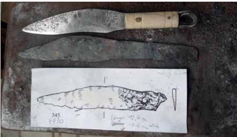
Abb. 2: Ausgehend von der Zeichnung eines Fundes aus Kalkriese (unten) wurde ein römisches Messer (oben) hergestellt; in der Mitte der eiserne Messerrohling.
