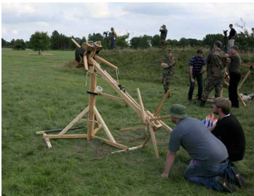
Abb. 5: Geschütz vom Typ Cremona, gebaut in Osnabrück, bei der Erprobung in Delmenhorst (Foto: Günther Moosbauer)
