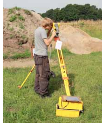
Abb. 3: Sommer 2012: Tobias Uhlig beim Einmessen von Funden mit dem Tachymeter (Foto: Grabungsteam Kalkriese).
